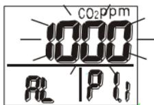
Use los botones de flecha ▲ ▼ para ajustar el valor. Cada presión del botón ajusta en 100 ppm (100 ~ 9900ppm). Una vez fijo el valor deseado, presione **SET** para entrar a P1.2 y fijar el límite inferior (utilizando el mismo método que para el límite alto). Cuando termine, presione **SET** para guardar o **CAL/ESC** para salir sin guardar y regresar a P1.0.
