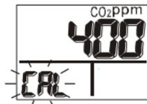
1. Coloque el medidor en la cámara de calibración de 400 ppm. Encienda el medidor y mantenga presionado los botones **CAL/ESC** y **▲/DP WB** simultáneamente para entrar en modo de calibración de CO<sub>2</sub>. En la pantalla LCD destellará 400ppm y "CAL".
