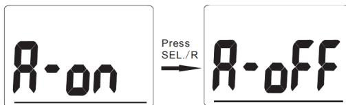
Lorsque l'alarme est activée, appuyez sur la touche « SET » pour enregistrer le paramètre, puis passez au paramétrage de l'alarme de dépassement de CO<sub>2</sub>.
