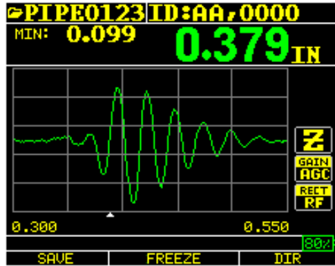
倒“V”光标的 RF（整流）信号表示所在部位正在进行测量
