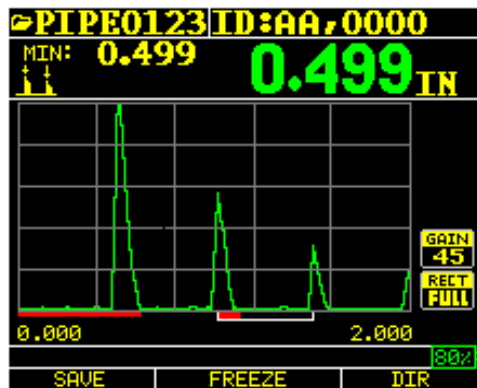
回波-回波之彩色波形、文件名、id、最小值、大字体厚度值、回波-回波、范围、回波、消隐、增益、整流、电池寿命、保存、冻结和目录。
