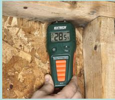
使用直接探针测定法测量在石块和其它建筑材料中的湿度（以百分数形式）
