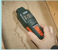
使用非侵入式无探针技术测量各种建筑材料中的相对湿度
