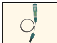
Cable de extensión acoplado al medidor
