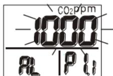
Use os botões de seta ▲ ▼ para ajustar o valor. Cada pressão do botão ajusta em 100 ppm (100~9900 ppm). Quando o valor desejado é definido, pressione **SET** para entrar em P1.2 a fim de definir o limite inferior (usando o mesmo método que usou para o limite superior). Quando terminar, pressione **SET** para salvar ou **CAL/ESC** para sair sem salvar e retornar a P1.0.
