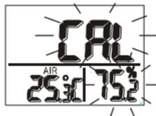
**NOTA:** Calibrações de um ponto único também podem ser feitas. Para calibrar somente 33 %, pressione **CAL/ESC** e pare após a calibração a 33% estar concluída. Para calibrar somente a 75 %, pressione **▲/DP WB** ou **MXN/AVG / ▼** em 5 minutos após iniciar a calibração a 33 %.
