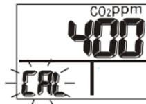
1. Coloque o medidor na câmara de calibração de 400 ppm. Ligue o medidor e mantenha pressionados botões **CAL/ESC** e **▲/DP WB** simultaneamente para entrar no modo de calibração de CO<sub>2</sub>. 400 ppm e "CAL" piscarão no LCD.
